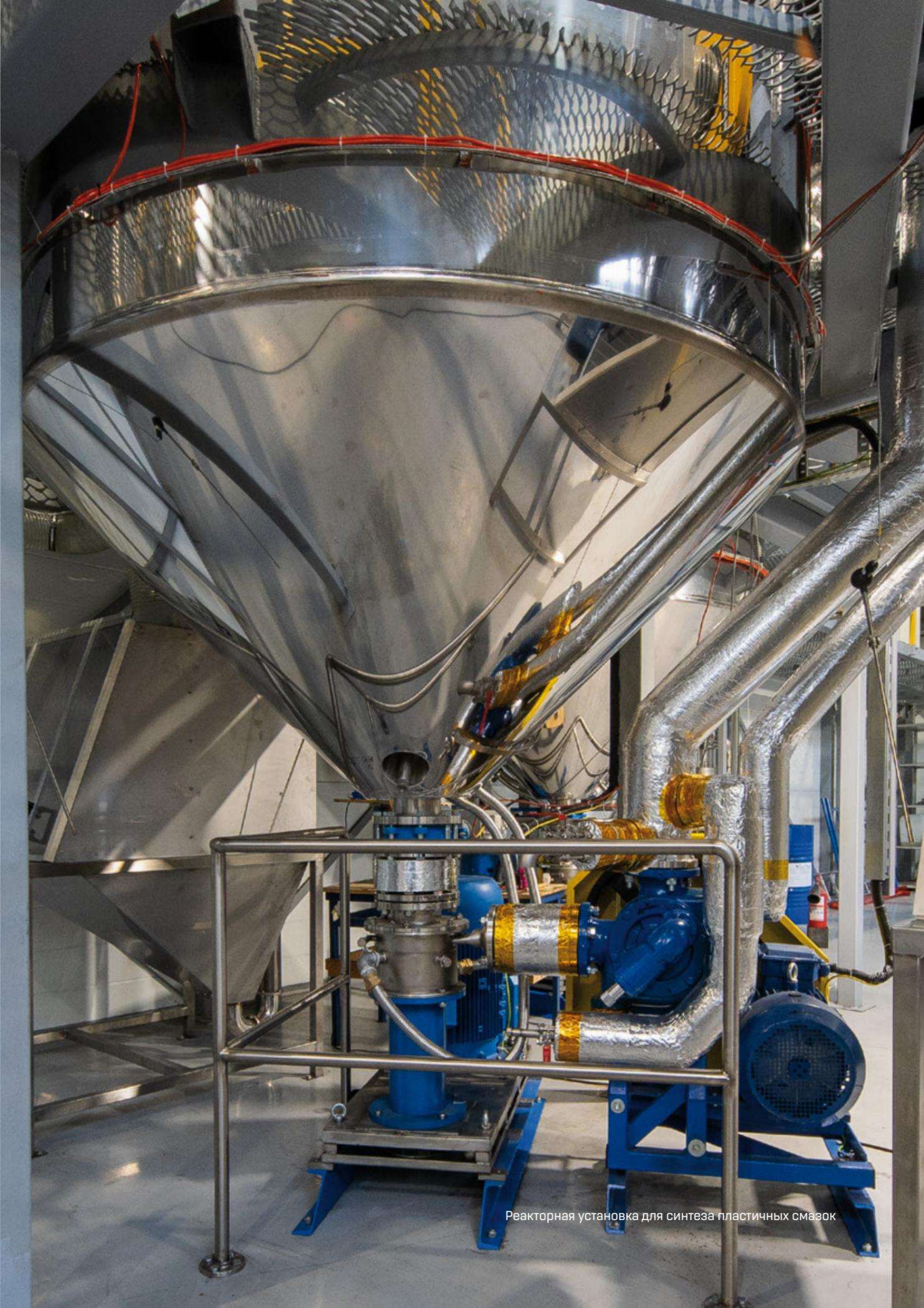
Реакторная установка для синтеза пластичных смазок
