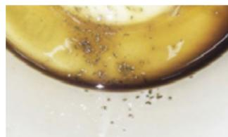
Металлическая стружка является верным признаком снижения HTHS-вязкости и разрыва масляной пленки
