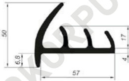
Профиль уплотнительный на двери (57мм, 2,6м) 829381
