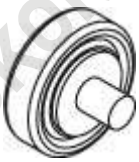
Ролик (Палец 6мм клепается) D=24 мм
