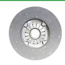
D накладок наружный 400 мм D накладок внутренний 215 мм Применяемость Трактора и спец. техника
