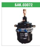
Тип 24/24 100-3519200 Аналог Ход мембраны/пружины 57/67 мм Шток короткий Уплотнитель штока ПЫЛЬНИК
