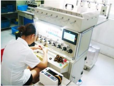
Автоматическая намоточная машина
