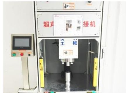
Ультразвуковой сварочный аппарат
