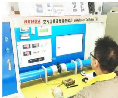
Тестер производительности датчика массового расхода воздуха (MAF)
