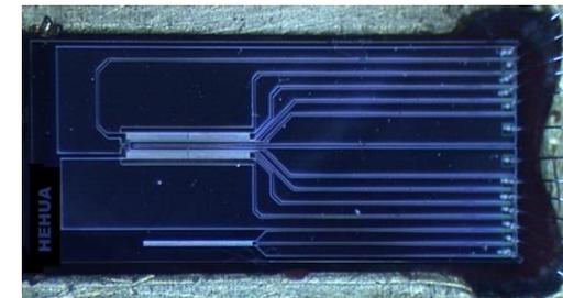
В датчиках MAF используются проверенные MEMS технологии
