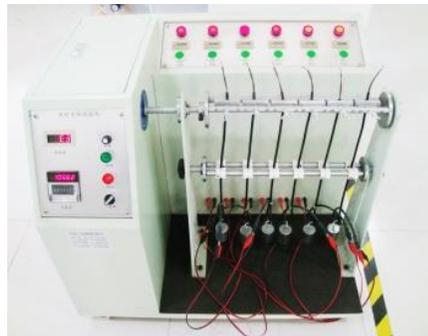
Тестер на гибкость провода
