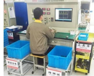
Тестер производительности датчика
