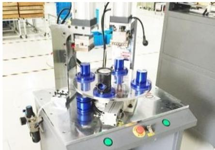
Автоматическая машина для приклеивания
