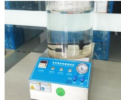
Тестер герметизации высокого напряжения
