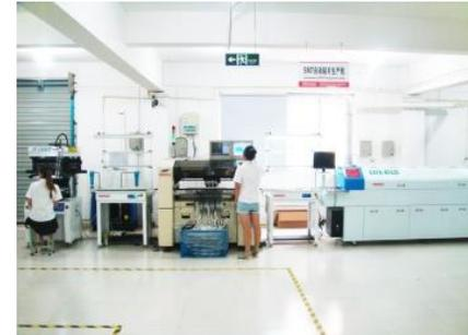
Автоматизированная производственная линия SMT
