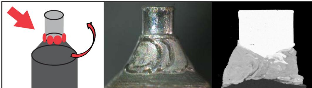
Обычная лазерная сварка
