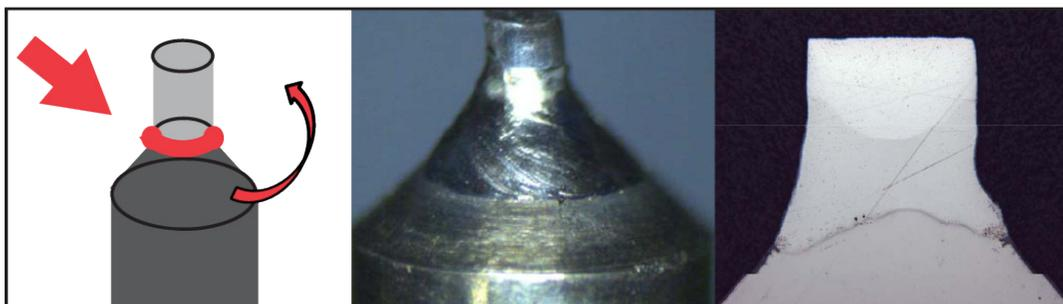
Лазерная сварка TORCH 360
