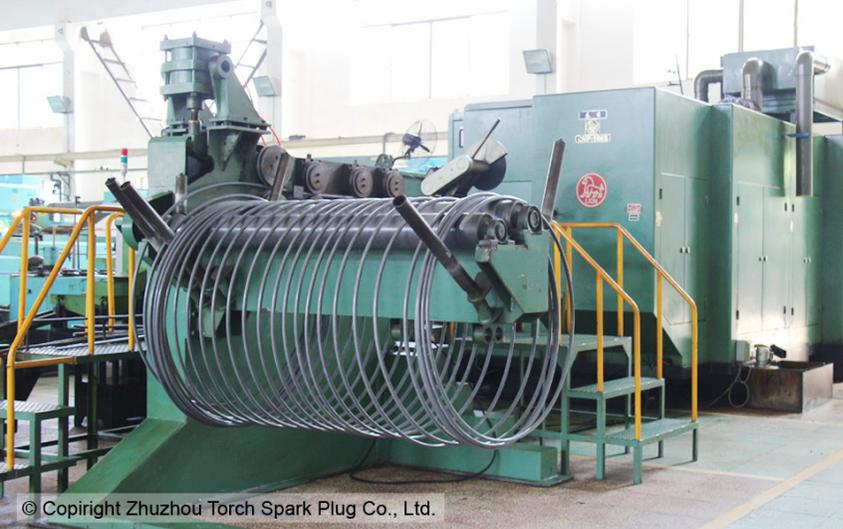
Оборудование холодной экструзии
