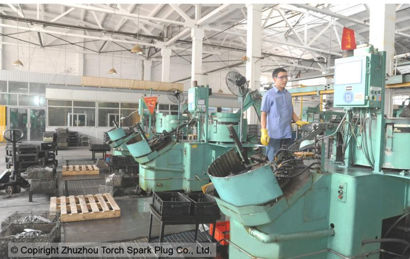
Автоматическое резьбонакатывания корпуса
