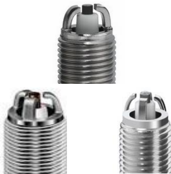
Многоэлектродные свечи НЕ «многоискровые»!
