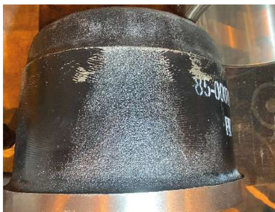
При механической обработке резец доставал не до всей поверхности из-за некачественной отливки
