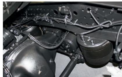
**...а в задней – пневматика по четырехбаллонной схеме**
