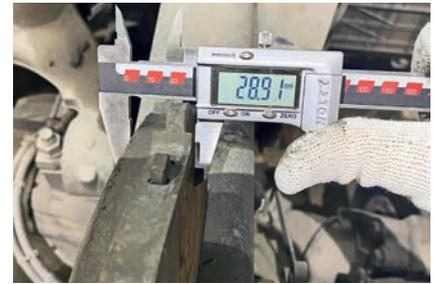
**Отмечена равномерность износа фрикционных по всей контактной площади**
