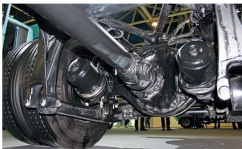
**Тормоза на шасси Valdai 18 пневматические, с кулачковым разжимом колодок**
