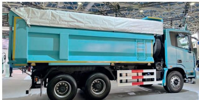
**Кузов в 19 кубометров для трехосного самосвала, пожалуй, великоват. Но вспомним, что Valдай 33 проектировали в Китае**
