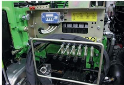
Пульт управления надстройкой расположен слева за кабиной шасси
