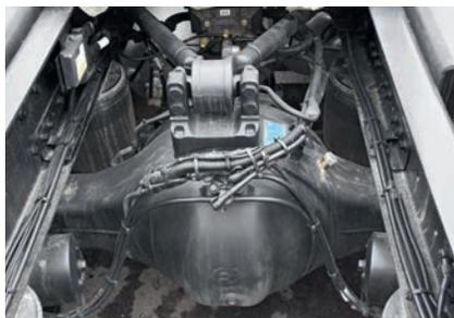
**13-тонный ведущий мост Hande оснащен принудительной блокировкой межколесного дифференциала**
