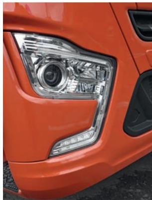
**Оптика на тягаче светодиодная. Как передние фары, так и задние фонари**
