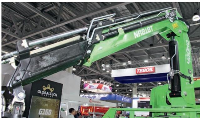
Гидроцилиндры телескопирования стрелы расположены снаружи секций, что упрощает ремонт и замену
