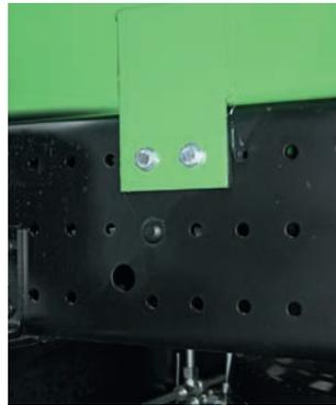
**Надрамник с крепежными пластинами идеально точно садится на раму шасси**
