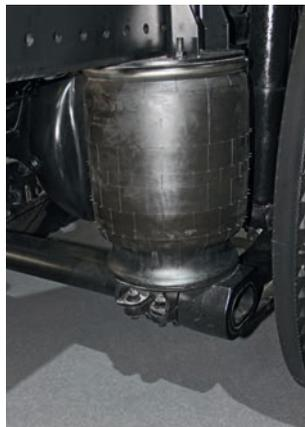
**Пневмоподвеска, в отличие от рессор, лучше адаптируется к неполной нагрузке**
