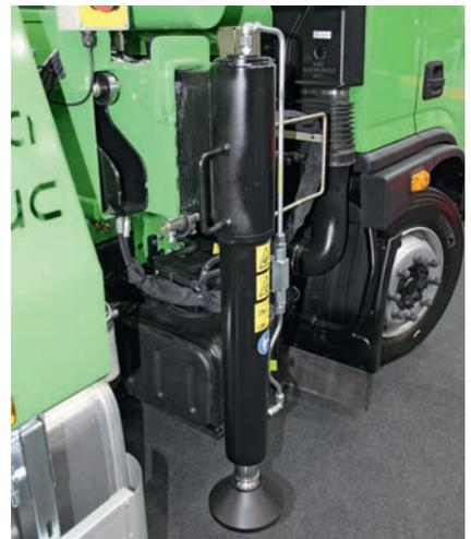
Передние аутригеры установлены на раме КМУ и выдвигаются вручную
