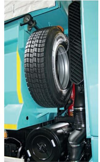
Закреплено на передней стенке самосвального кузова
