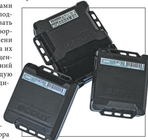
**Мониторинговые терминалы «СКАУТ» могут работать с любыми датчиками или системами автомобиля**
