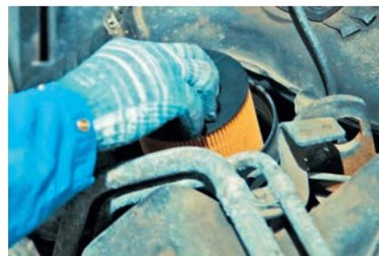
**Фильтроэлементы в виде сменных картриджей имеют геометрию, точно соответствующую заводскому чертежу**
