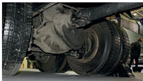
Средний мост проходной, с межосевым блокируемым дифференциалом
