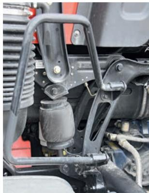
**Огромная кабина подвешена на четырех пневматических амортизаторах**
