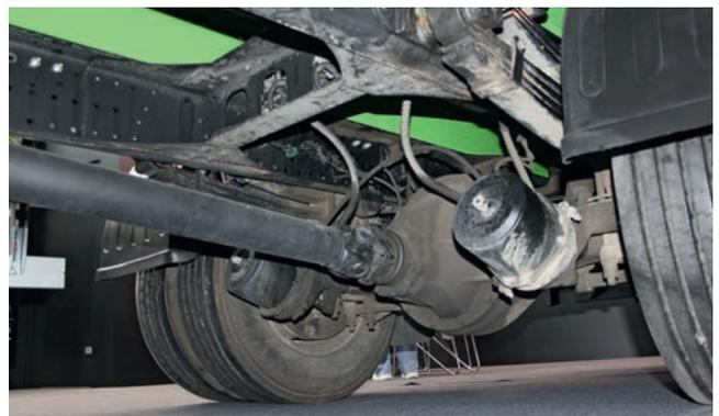
Ведущий мост шасси Foton – с одноступенчатым гипоидным редуктором. Тормоза пневматические
