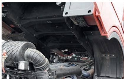
**На фото хорошо видна формованная тепло- и шумоизоляция кабины**
