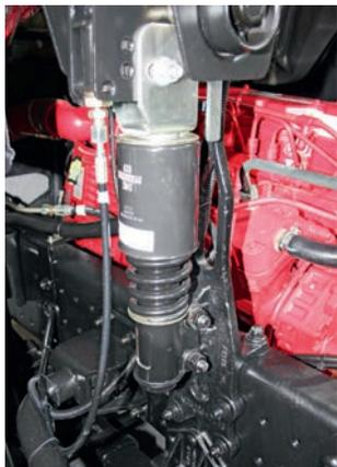
**Сзади кабина шасси опирается на пружинно-гидравлические амортизаторы**
