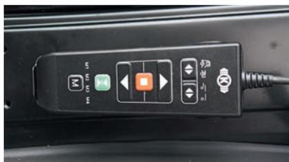
**С помощью этого пульта, закрепленного слева под водительским сиденьем, регулируют заднюю пневмоподвеску**
