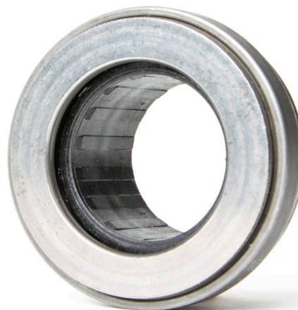
Рисунок 2: Пластмассовая втулка выжимного подшипника не смазывается
