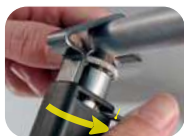
Разрезание оплетки методом вращения
