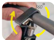
Разрезание оплетки методом вращения
