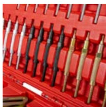
Набор для регулировки и установки сцепления трансмиссии
