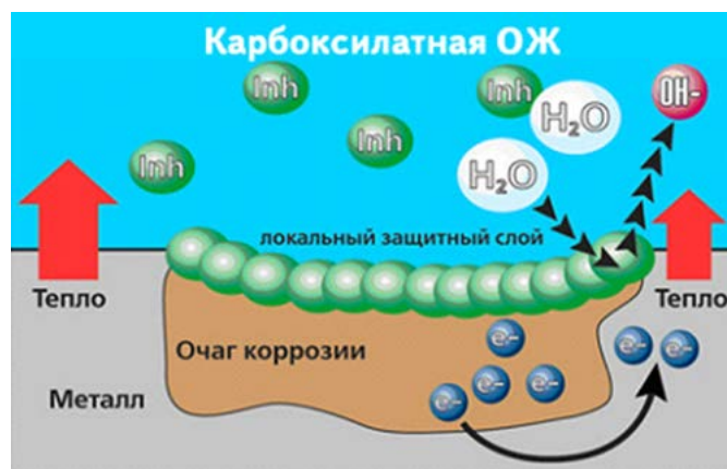
Рисунок 11. Принцип работы карбоксилатных ОЖ
