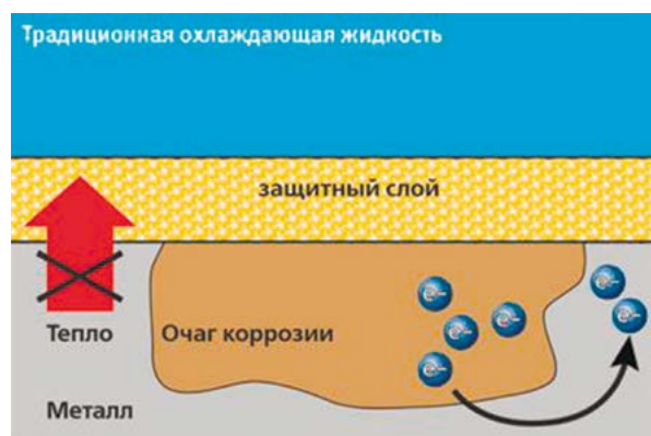
Рисунок 10. Принцип работы силикатных ОЖ
