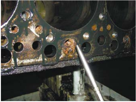
Рисунок 9. Блокировка каналов двигателя осадками
