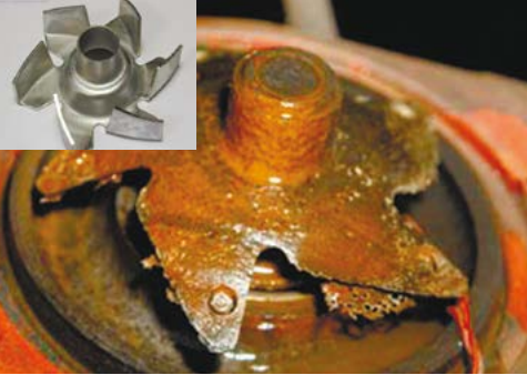
Рисунок 8. Разрушенная кавитацией крыльчатка помпы
