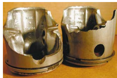
Рисунок 3. Разрушение детали в результате заклинивания из-за перегрева
