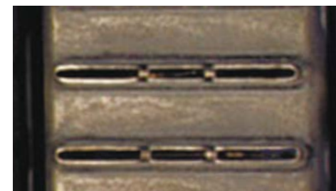
Радиатор после использования карбоксилатной ОЖ
