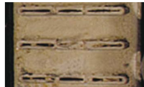
Радиатор после использования силикатной ОЖ
