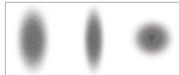
Пятно факела распыления окрасочного пистолета
